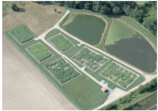
ე.წ. „აშენებული ჭაობების“ ტიპის გამწმენდი საფრანგეთის ქალაქ სენტ-ეტიენის მიმდებარედ
