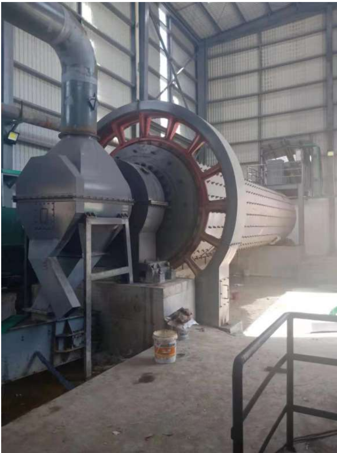
სურათი 3.1.5. დასამონტაჟებელი წისქვილი.
