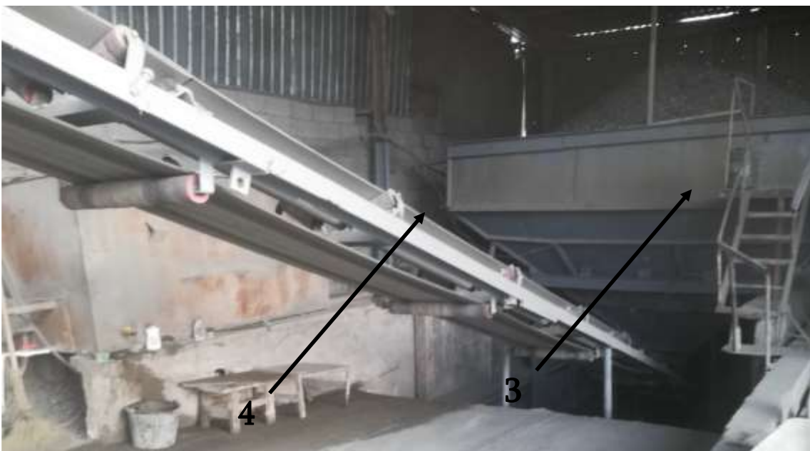
სურ. 3.1.2. ნედლეულის მიმღები ბუნკერი და ლენტური ტრანსპორტიორი.
