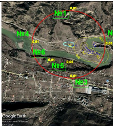
აზოტის ოქსიდის (კოდი 304) მაქსიმალური კონცენტრაცია 500მ-ანი ზონის საზღვარზე (წერტილები N1,2,3,4) და უახლოესი დასახლებული ზონის საზღვარზე (წერტილები N5, N6)
