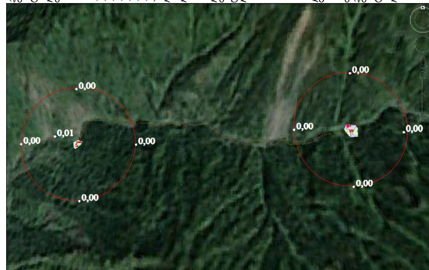
გოგირდის დიოქსიდის (კოდი 330), ნახშირბადის ოქსიდის (კოდი 337), ნაჯერი ნახშირწყალბადების ნავთის ფრაქციის (კოდი 2732) და შეწონილი ნაწილაკების (კოდი 2902) მაქსიმალური კონცენტრაციები 500 მ-ნი ზონის საზღვარზე (წერტილები № 1,2,3,4,5,6,7,8) და დასახლებული ზონის საზღვარზე (წერტილი. № 9)
