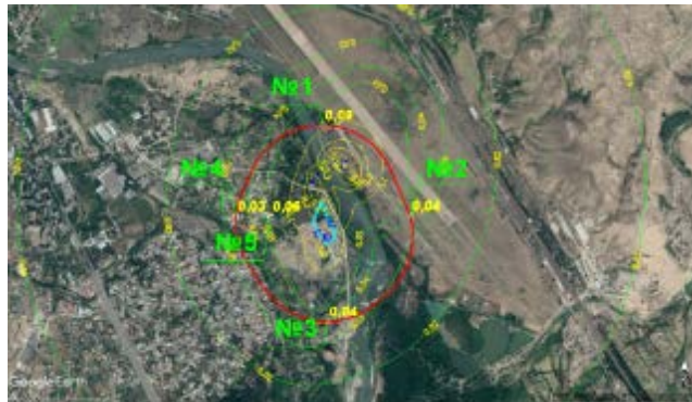
შეწონილი ნაწილაკების (კოდი 2902) მაქსიმალური კონცენტრაცია 500მ-ანი ზონის საზღვარზე (წერტილები N1,2,3,4) და უახლოესი დასახლებული ზონის საზღვარზე (წერტილი N5)
