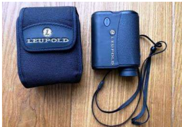
სურათი 17. ლაზერული მანძილმზომი “Leupold RX-1000”
