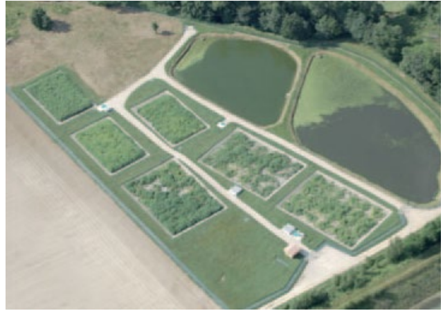
ე.წ. „აშენებული ჭაობების“ ტიპის გამწმენდი საფრანკეთის ქალაქ სენტ-ეტიენის მიმდებარედ
