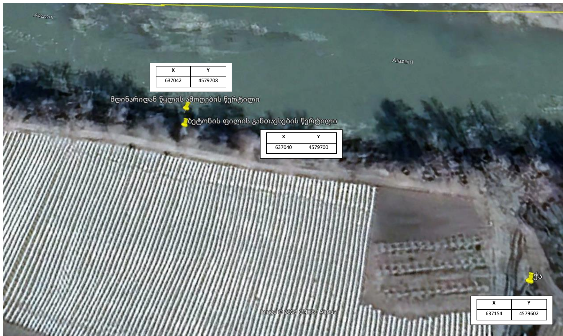
სურ 2 - მდინარიდან წყალაღების, ბეტონის ფილისა და ბეტონის ჭის განთავსების წერტილები
