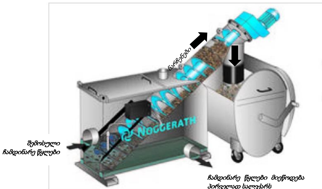
ნახაზი 4.2.4.1. ავტომატური სკრინინგის სისტემის მუშაობის პრინციპიალური სქემა
