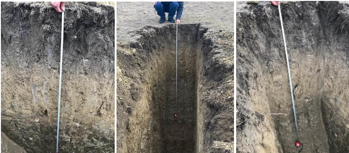
სურათი N9 . გაყვანილი საინჟინრო-გეოლოგიური შურფები
