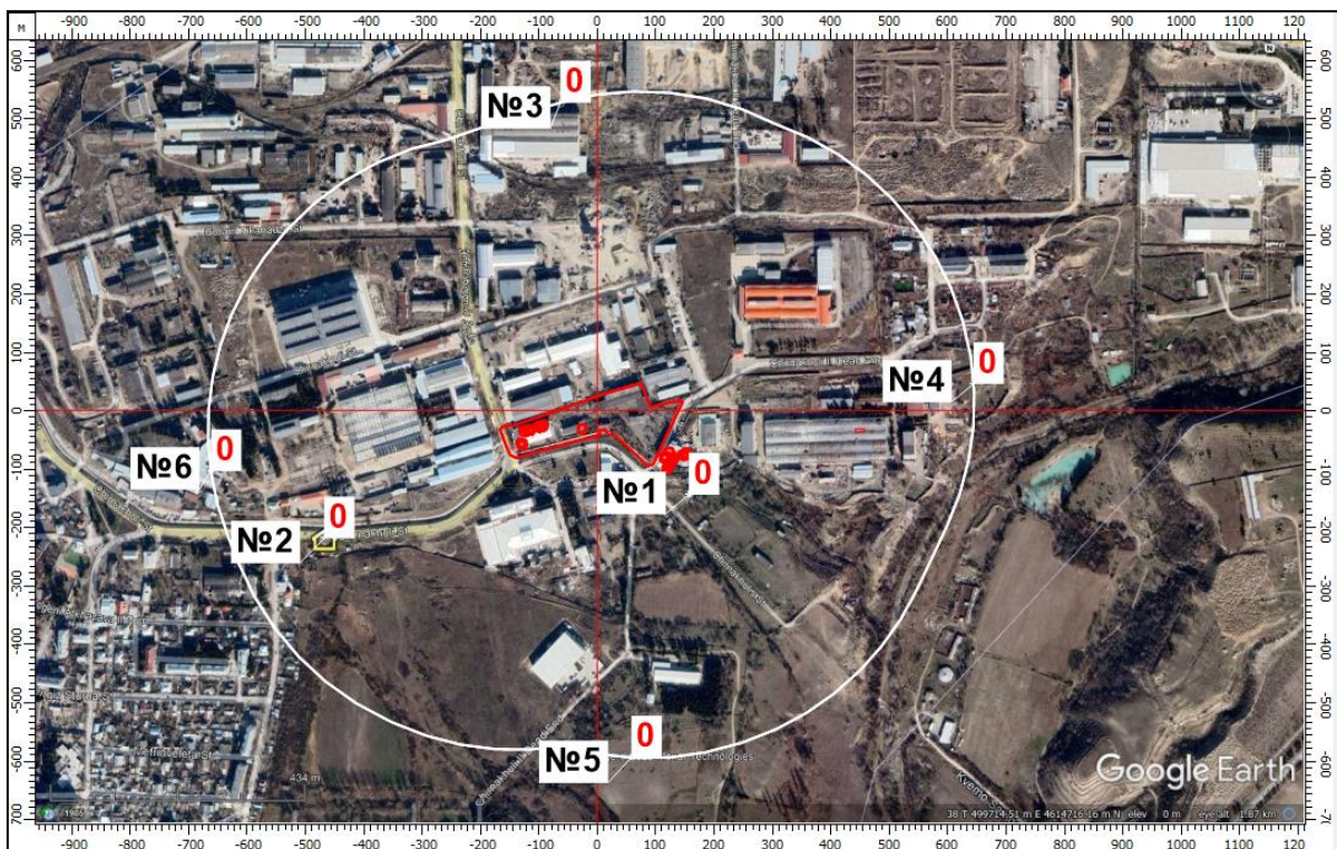
ნივთიერება: 0416 ნაჯერი ნახშირწყალბადების ნარევი C6-C10. მაქსიმალური კონცენტრაცია უახლოეს საცხოვრებელ სახლთან წერტილი N1, N2 და 500 მ-ნი ნორმირებული ზონის საზღვარზე წერტილი N 3-5.
