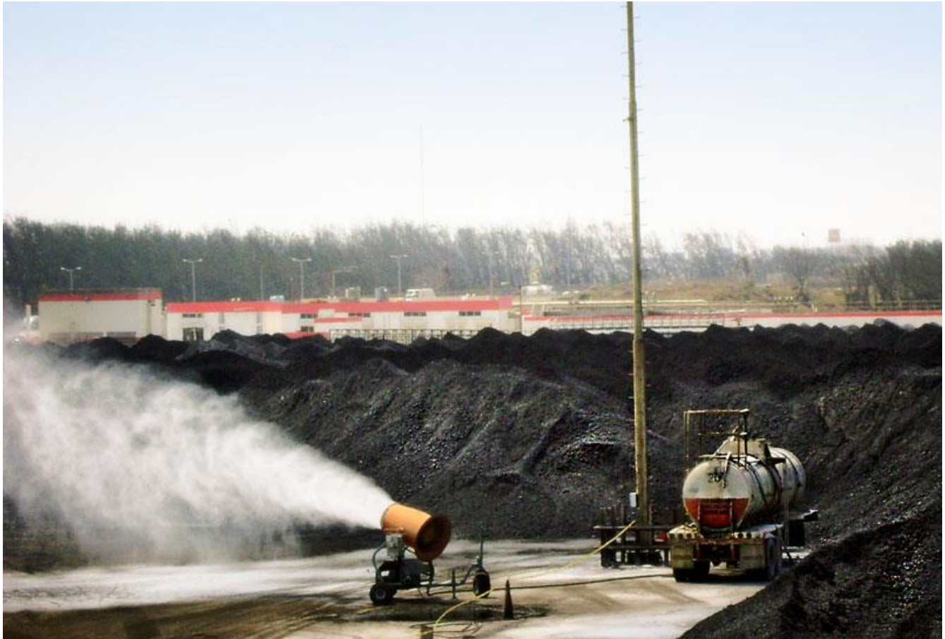
სურათი 19. წყლის ნისლის წარმომქნელი დანადგარის ფოტო ილუსტრაცია და ტექ.მახასიათებლები
