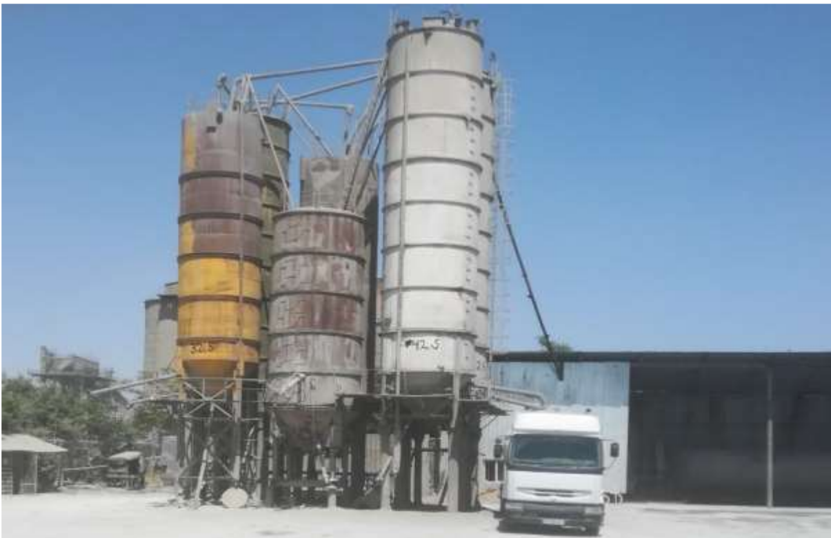
სურ. 2.2.4. ცემენტის სილოსიდან ცემენტის გაცემა ცემენტბზიდში.
