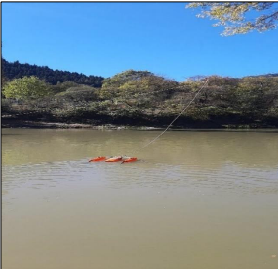
სურათი 6-7 - მდინარეებზე წყლის ხარჯის გაზომვის პროცესი
