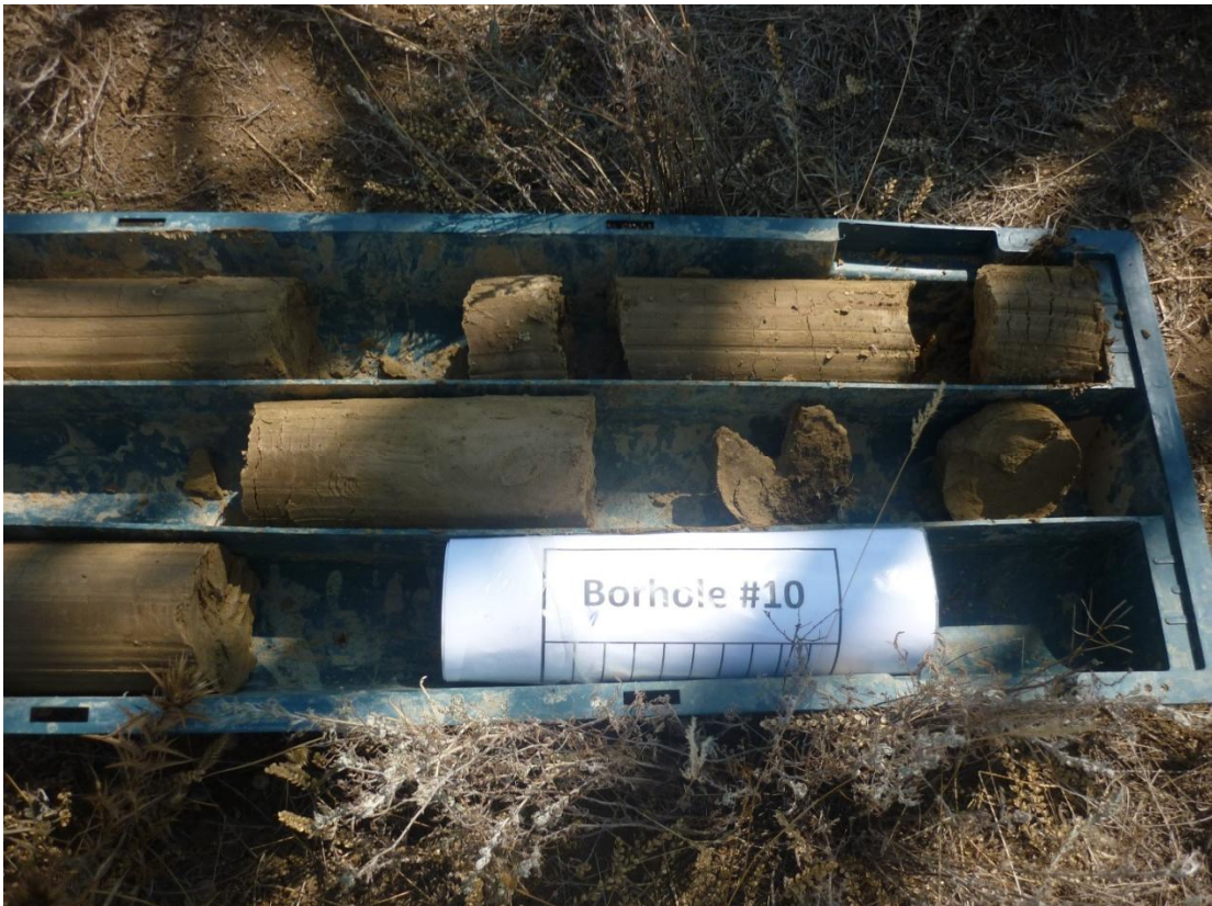
სურათი №56. №10 ჭაბურღილიდან ამოღებული კერნის ფრაგმენტები
