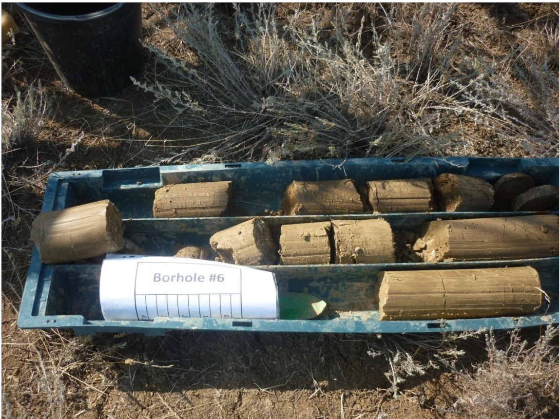
სურათი №48. №6 ჭაბურღილიდან ამოღებული კერნის ფრაგმენტები
