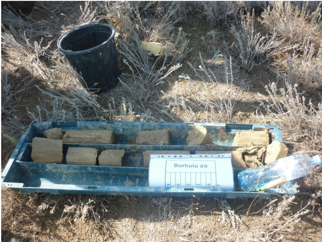
სურათი №54. №9 ჭაბურღილიდან ამოღებული კერნის ფრაგმენტები
