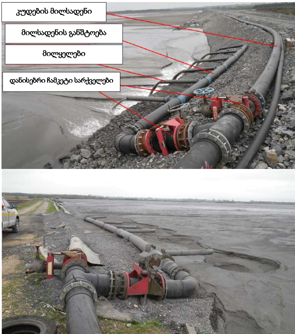
ნახაზი 5.5.16. მაღალი სიმკვრივის შესქელებული კუდების თხელ შრეებად განთავსება, ლიშინის საბადო, ირლანდია.
