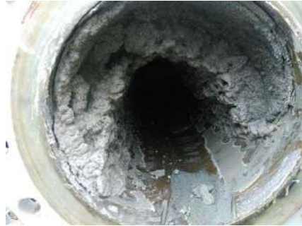
ნახაზი 4.18.9. მდგრადი სილიკატურ-კარბონატული ნალექით დაფარული მილის კედლები
