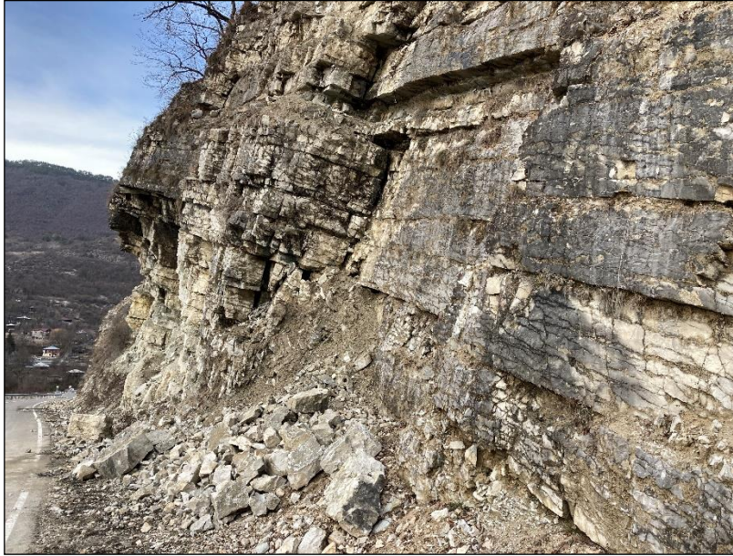
ფოტო 5.4.4.9.1. წყალსაცავის მარცხენა სანაპიროზე ნაპრალები შრეების პერპენდიკულარულად არის მიმართული (K2t-cn)
