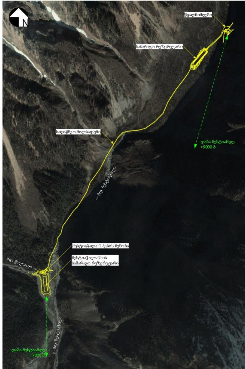
სურათი 2.2. მესტიაჭალა 1 ჰესის ნაგებობების განლაგების სქემა
