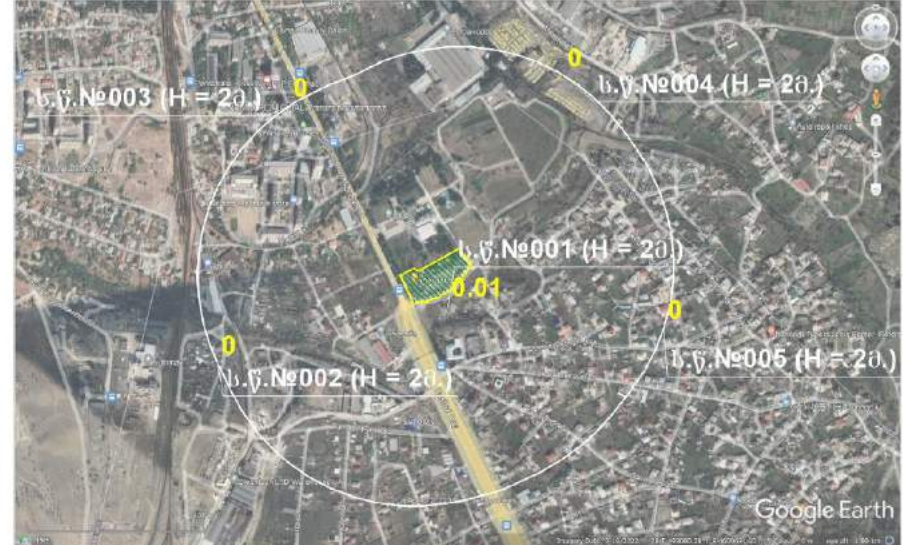
ნავთის ფრაქციას (კოდი 2732) მაქსიმალური კონცენტრაცია 500მ-ანი ზონის საზღვარზე(წერტილები № 2,3,4,5) და უახლოესი დასახლებული ზონის საზღვარზე (წერტილი №1)
