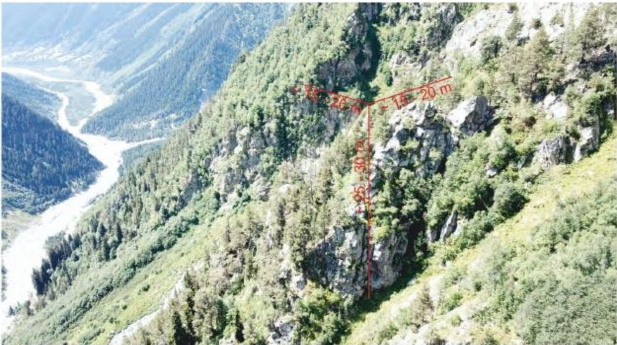
სურ. 8-18: არასტაბილური კომპლექსი დასავლეთ ფერდობზე (M-R5b). გაზომილი ქანის მოცულობა მერყეობს 5,000m 3 და 12,000 m 3 შორის (ძირითადად კლასი: ფართო მოცულობით ქანის ჩამოშლა). გაითვალისწინეთ დახრილი ბზარი ფერდობის პარალელურად.
