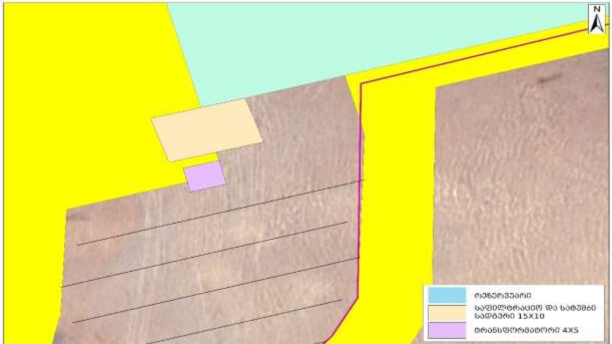
ნახაზი N1 საფილტრაციო-სატუმბი სადგურისა და ტრანსფორმატორის განთავსების ნახაზი
