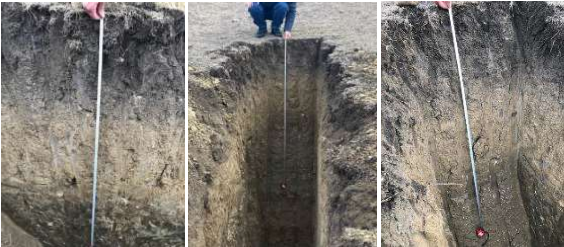
სურათი N9 . გაყვანილი საინჟინრო-გეოლოგიური შურფები
