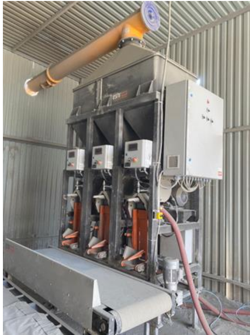
სურ. 6.1.1 - ცემენტის შესაფუთი დანადგარი
