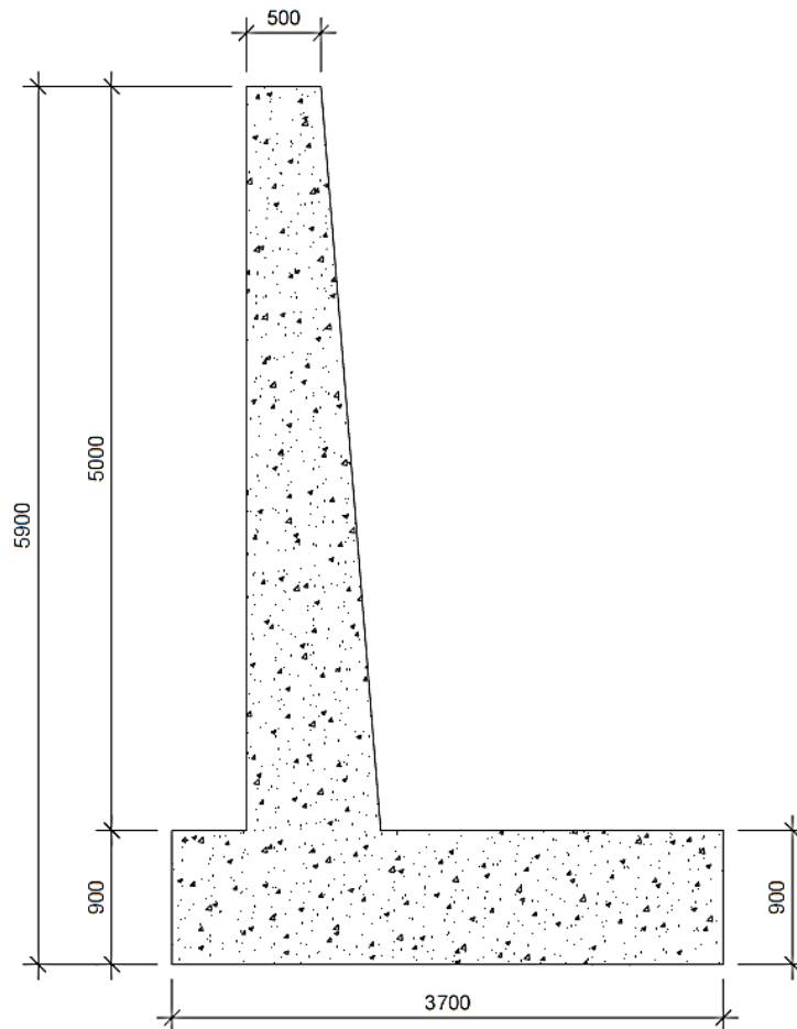
ნახაზი 4.5.1. ნაპირდამცავი კედლის ჭრილი, მასშტაბი 1:50
