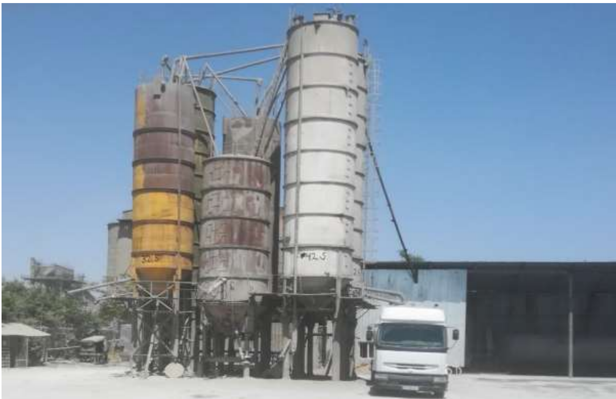
სურ. 3.1.4. ცემენტის სილოსიდან ცემენტის გაცემა ცემენტშიდში.
