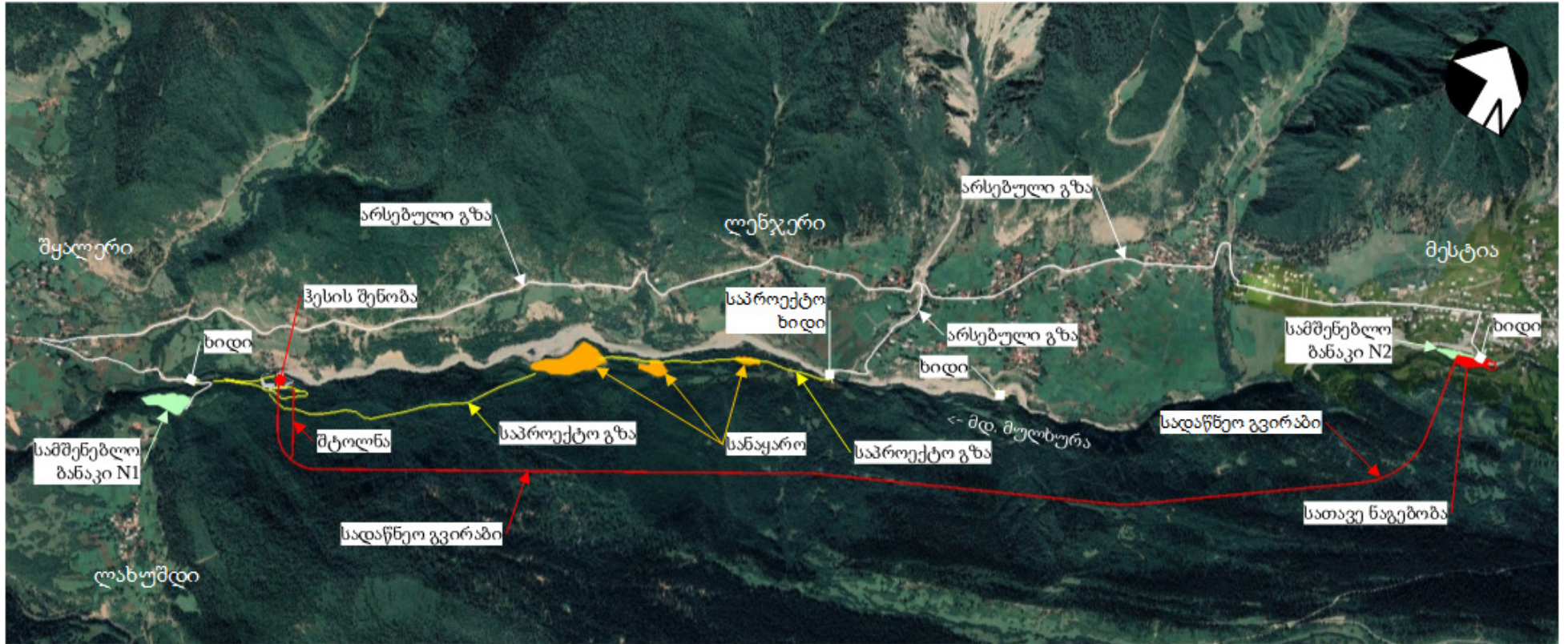
სურათი 3.1.1. „მულხურა ჰესი“-ს სიტუაციური სქემა (სქემა A3 ფორმატში თან ერთვის ანგარიშს)
