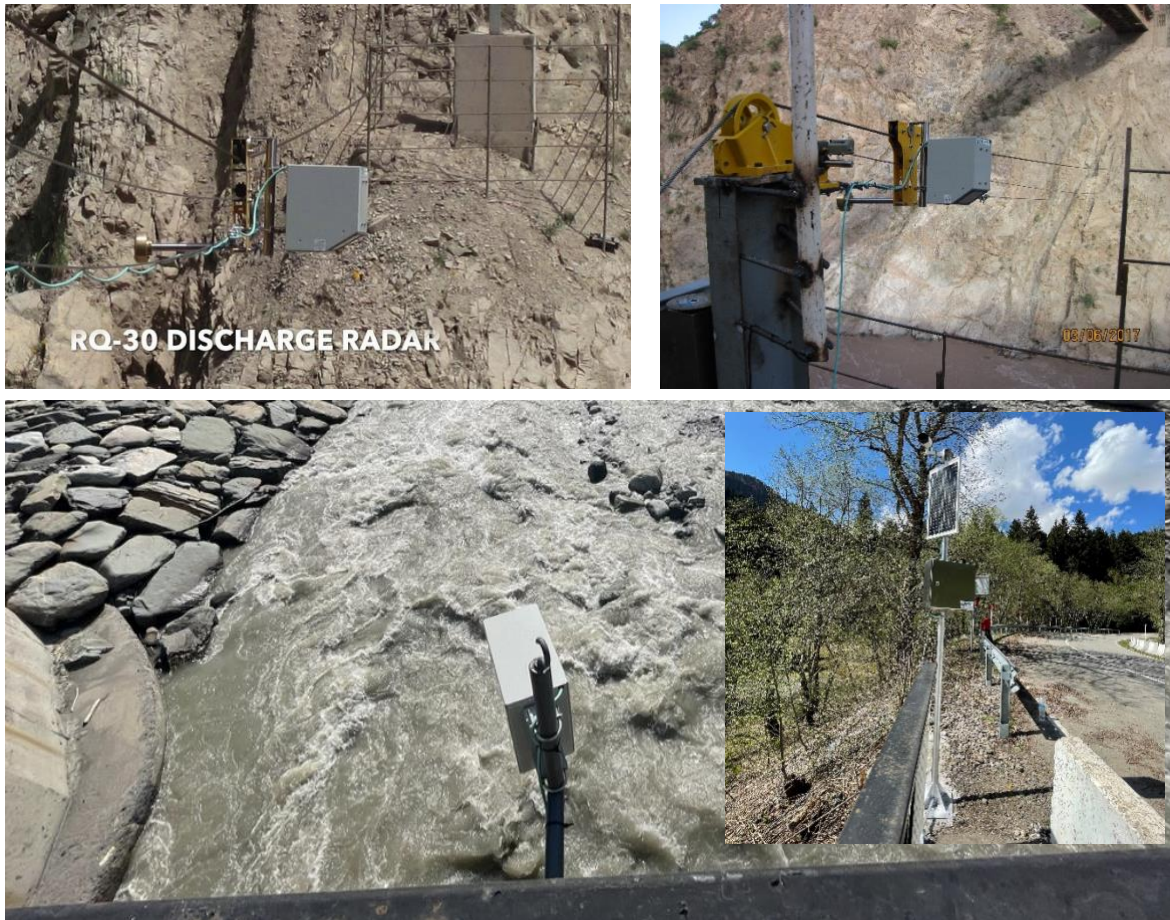
ფიგურა 2: რადარული უკონტაქტო ხარჯმზომი ავტონომიური სისტემების მონტაჟის სხვადასხვა მაგალითები (ტაჯიკეთი, საქართველო)
