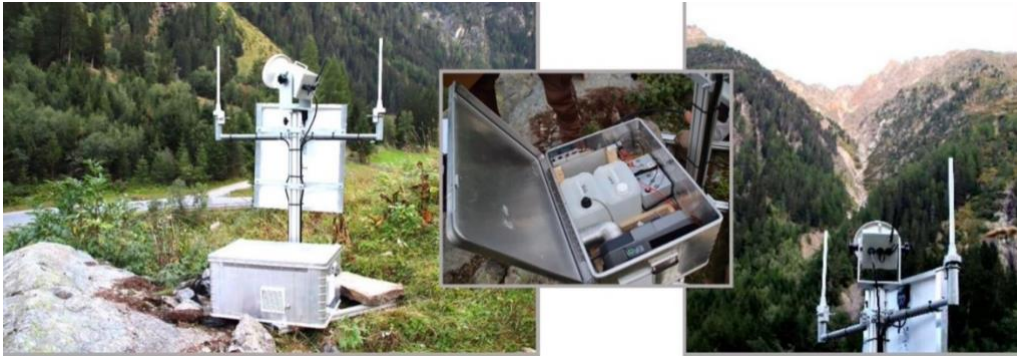
ფიგურა 3: ღვარცოფული პროცესების ადრეული გაფრთხილების სისტემა რადიო კომუნიკაციით - მასების მოძრაობის მაკონტროლებელი რადარული ავტონომიური სისტემა (ავსტრია)
