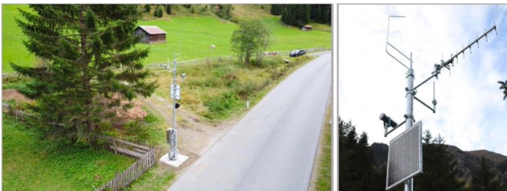
ფიგურა 4: ღვარცოფული პროცესების ადრეული გაფრთხილების სისტემა რადიო და GSM კომუნიკაციით - ცენტრალური მონაცემების/გაფრთხილებების შემკრები და მართვის ავტონომიური სისტემა (ავსტრია)
