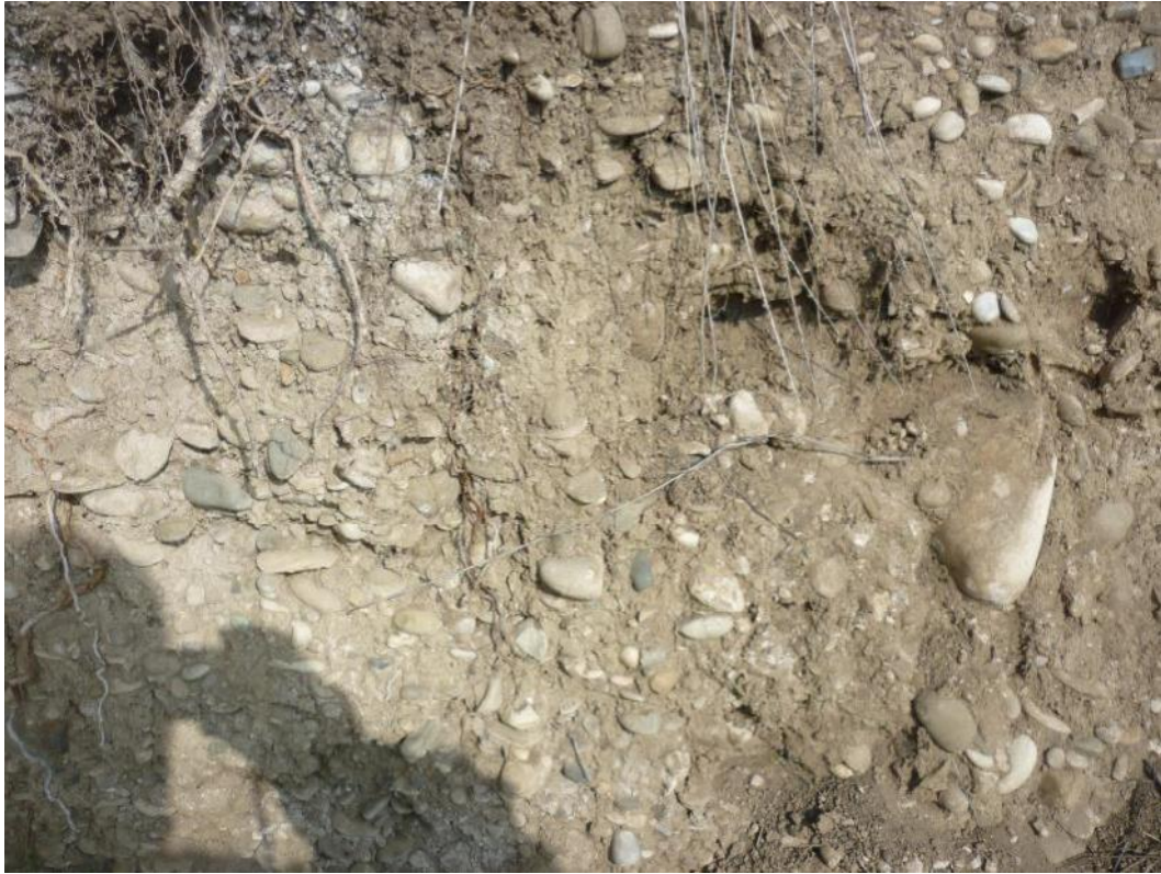
სურათი #17. 5-6 მონაკვეთის დასაწყისში, რკინიგზის ვაკისის ქვედა ნაწილი სადაც გაყვანილი იქნება მიწისქვეშა საკაბელო ტრასა, ლითოლოგიურად 1 მ სიღრმემდე წარმოდგენილია ტექნოგენური (tQIV) მსხვილანტეხოვანი გრუნტებით – ხრეშით და კენჭნარით ქვიშნარის შემავსებლით 25-35%-მდე.
