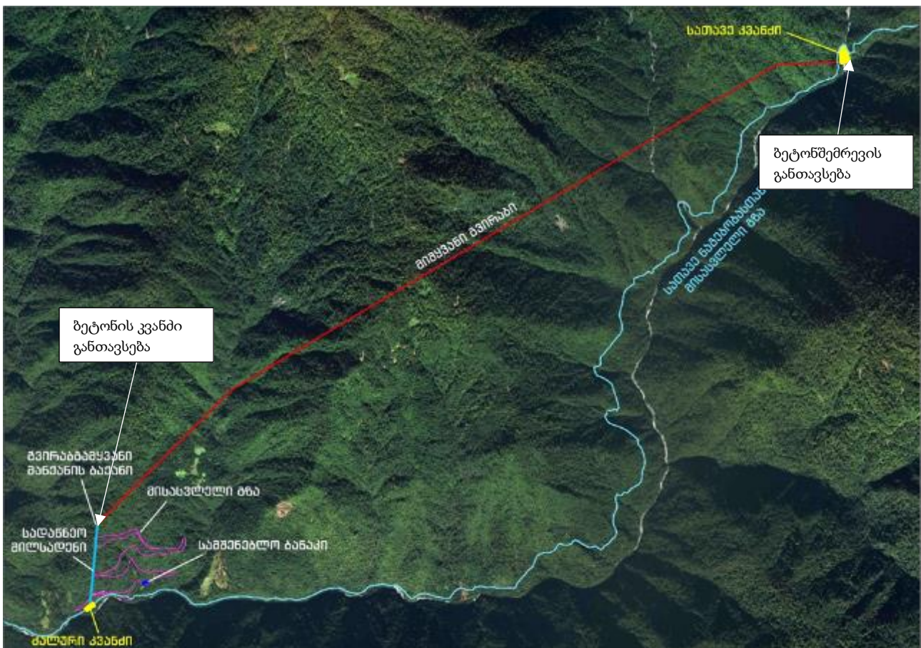
სურათი 2.2.1. ბეტონის კვანძისა და ბეტონშემრევი მცირე დანადგარის განთავსების წერტილები
