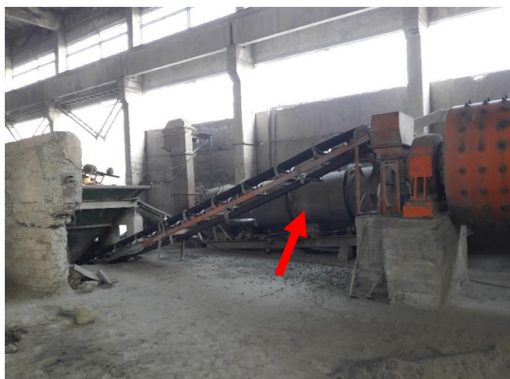
სურათი 2.1.4. ინერტული მასალის საშრობი დოლი და ლენტური ტრანსპორტიორი
