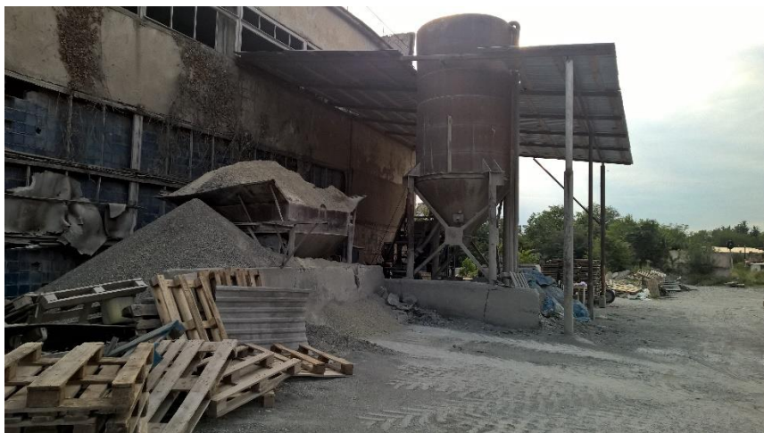
სურათი 2.1.9. ბლოკის საამქროს დანადგარი და გასაშრობად განთავსებული მზა პროდუქცია
