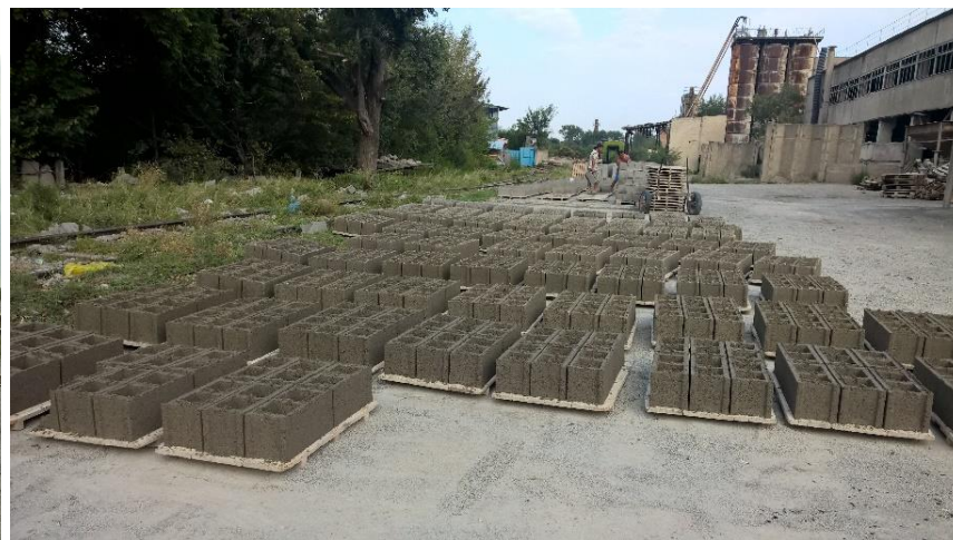
სურათი 2.1.9. ბლოკის საამქროს დანადგარი და გასაშრობად განთავსებული მზა პროდუქცია
