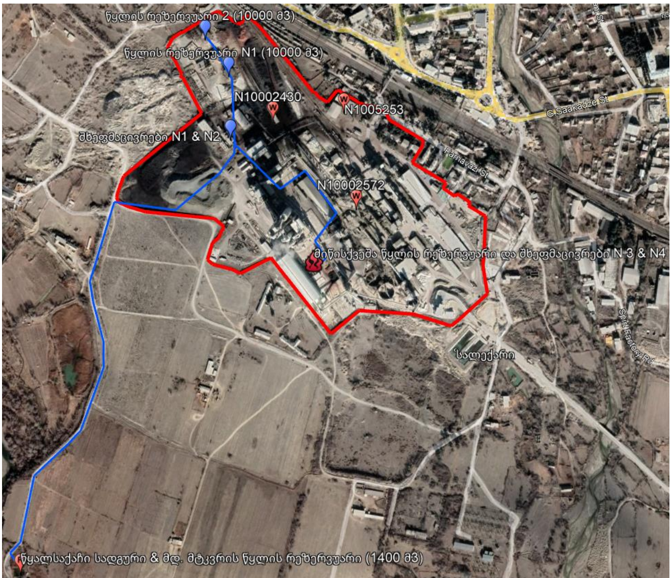
სურათი 21 კასპის ცემენტის ქარხნის წყალაღების და რეზერვუარების ძირითადი სისტემა
