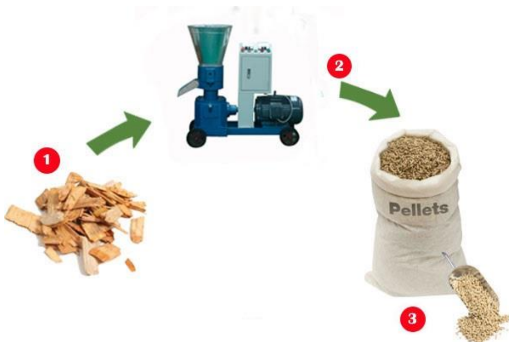
სურათი 4.5.2.9.3. ხე-ტყის მასალის დამუშავებიდან წარმოქმნილი ნარჩენების (ნახერხის, ბურბუშელას, ნათალის ) დამუშავების ტექნოლოგიური სქემა
