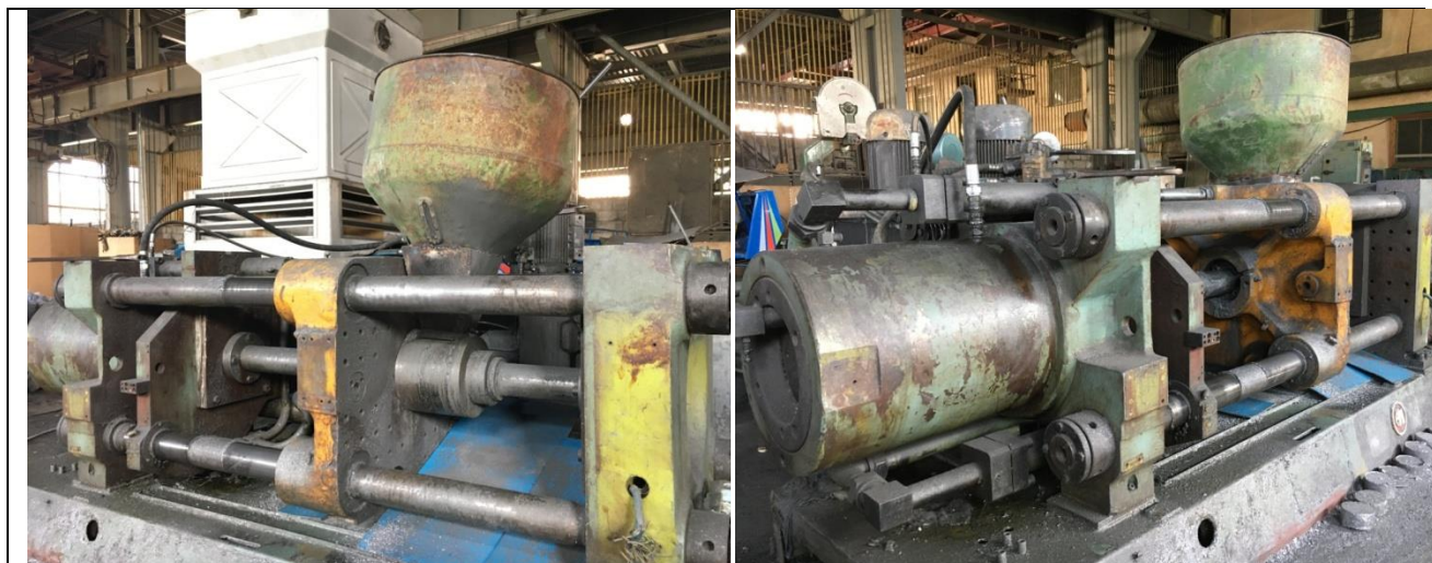
სურათი 2.5.2.3.2. დაქუცმაცებული ალუმინის დასაწნეხი დანადგარი (თვითნაკეთობა)
