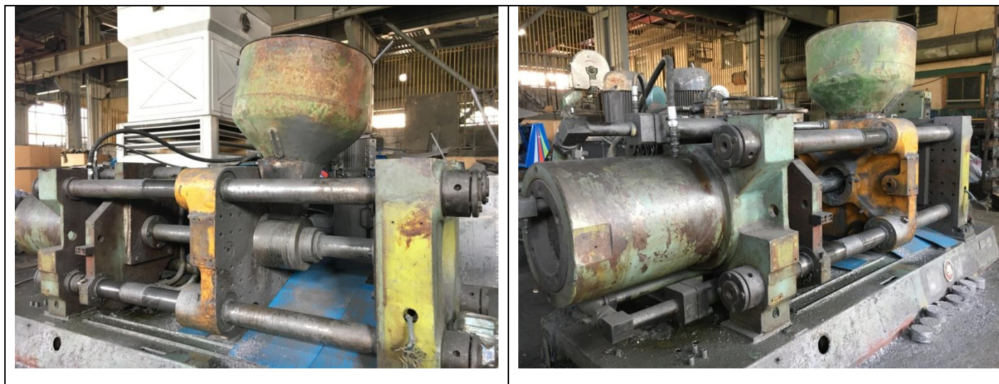
სურათი 4.2.3.2. დაქუცმაცებული ალუმინის დასაწეხი დანადგარი (თვითნაკეთობა)
