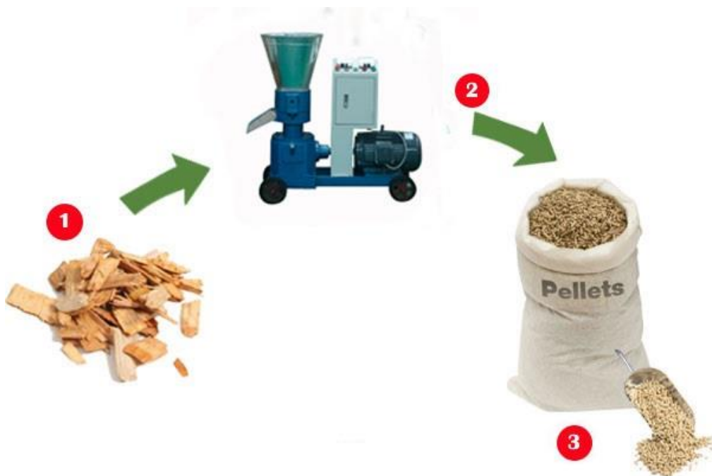
სურათი 4.2.9.3. ხე-ტყის მასალის დამუშავებიდან წარმოქმნილი ნარჩენების (ნახერხის, ბურბუშელას, ნათალის ) დამუშავების ტექნოლოგიური სქემა
