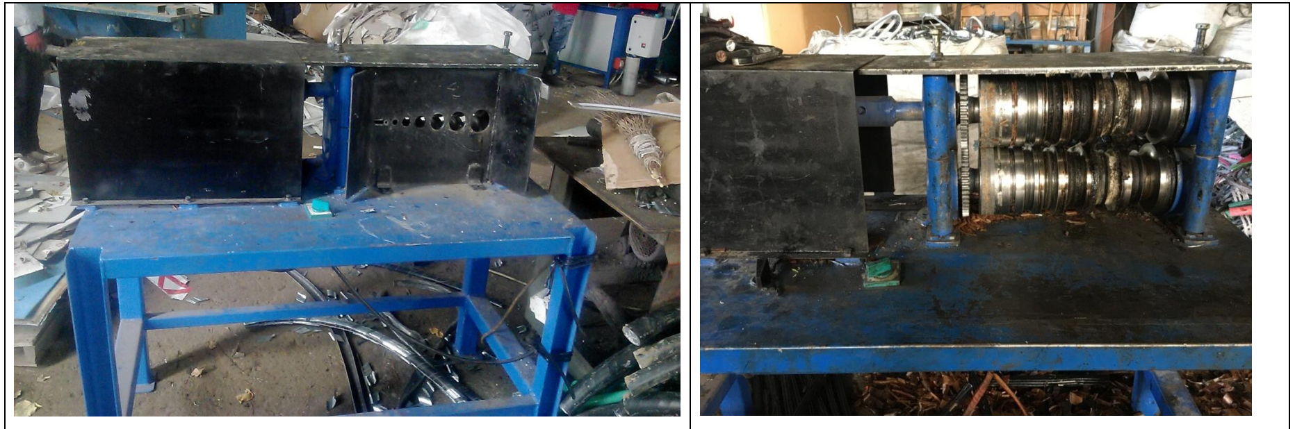
სურათი 4.2.8.4. ტექნოლოგიურ პროცესებში გამოყენებული ელექტროკაბელის გასაფცქვნიელი დანადგარი (თვითნაკეთი)
