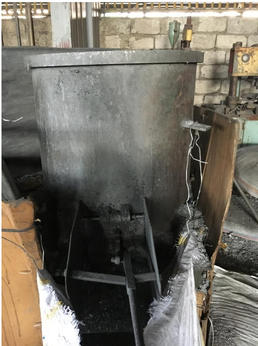
სურათი 4.2.3.1. ალუმინის ქილის დასაფქვავი დანადგარი (თვითნაკეთი)
