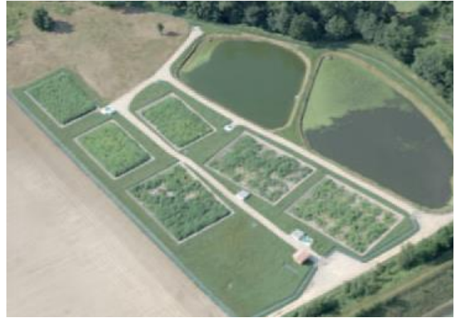
ე.წ. „აშენებული ჭაობების“ ტიპის გამწმენდი საფრანგეთის ქალაქ სენტ-ეტენის მიმდებარედ
