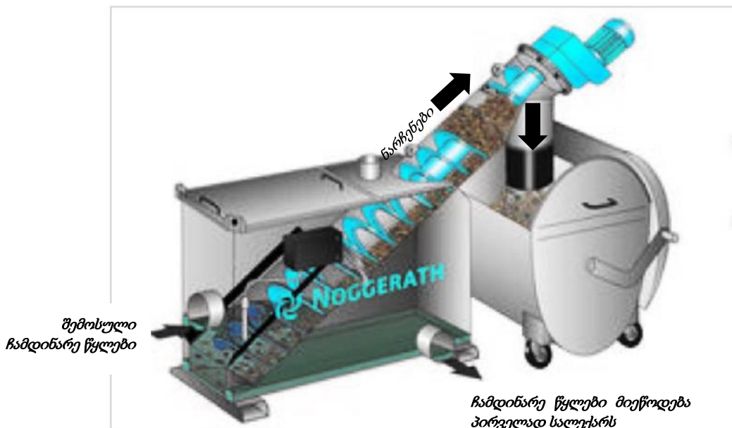
ნახაზი 4.2.4.1. ავტომატური სკრინინგის სისტემის მუშაობის პრინციპიალური სქემა
