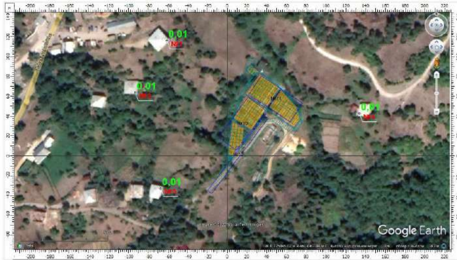
ნახშირბადის ოქსიდის (კოდი 337) მაქსიმალური კონცენტრაციები საკონტროლო წერტილებში (N:№ 1+ 4 უახლოეს დასახლებებთან და N:№ 5+ 8 ნორმირებულ 500 მეტრიან ზონის საზღვარზე)
