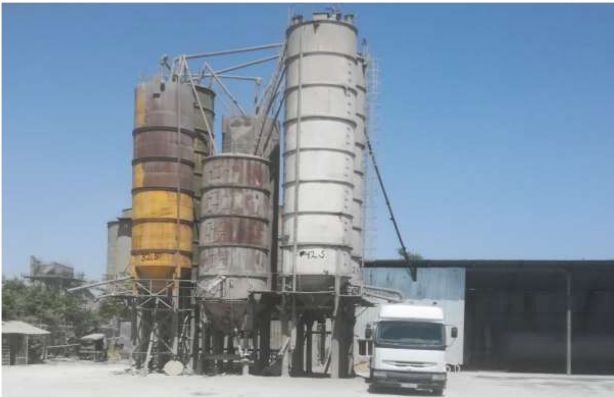
სურ. 3.1.4. ცემენტის სილოსიდან ცემენტის გაცემა ცემენტშიდში.
