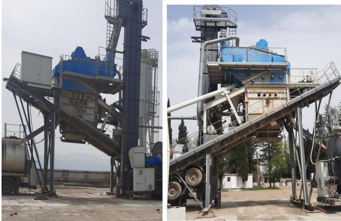
ასფალტუმერევი აწყობილ მდგომარეობაში
