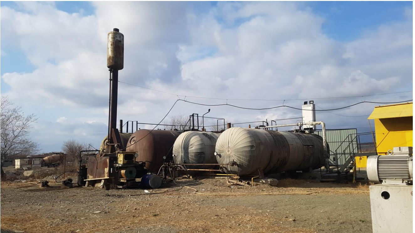
სურათი 3.2.3. ბიტუმის მიმღები და სახარში რეზერვუარები გამაცხელებელი ღუმელით.
