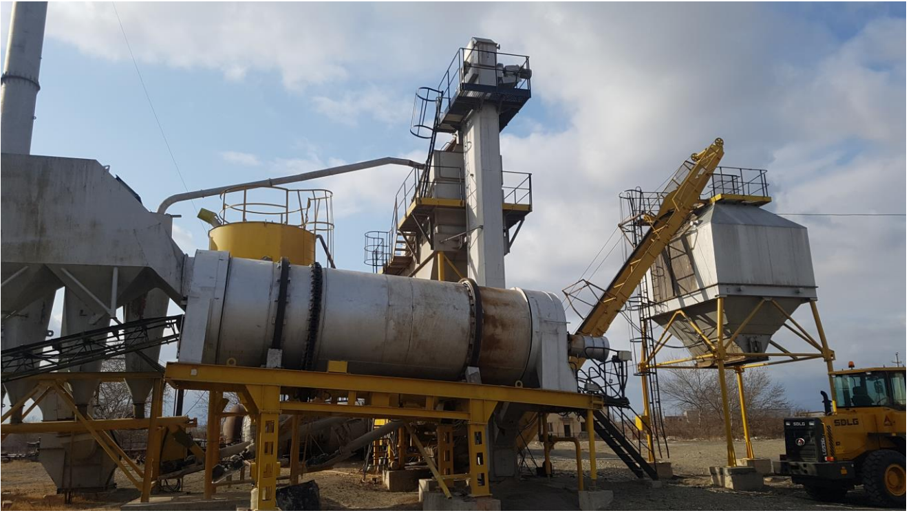
სურათი 3.2.7. მბრუნავი გამახურებელი დოლი.
