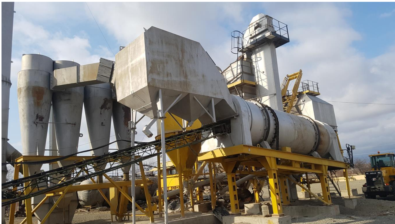
სურათი 3.3.1. ასფალტის ქარხანა მტვერდამჭერი სისტემით - ჯგუფური ციკლონი
