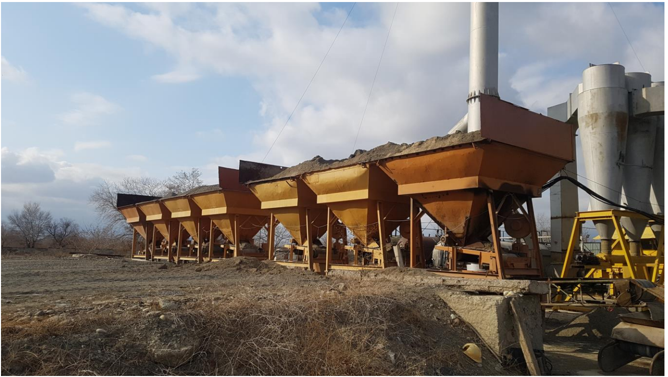
სურათი 3.2.4. ინერტული მასალების მიმღები ბუნკერები
