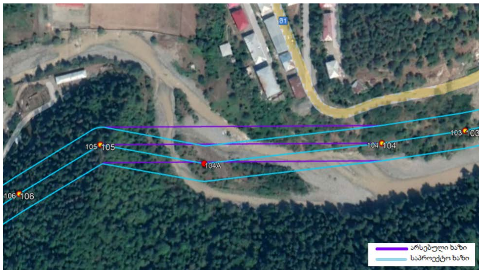
ნახაზი 4.5.5. სხალთა-შუახევის 35 კვ - ეგხ-ს არსებული და საპროექტო მონაკვეთები (ეგხ-ებს შორის მანძილის გაზრდისათვის მიღებული გადაწყვეტა)
