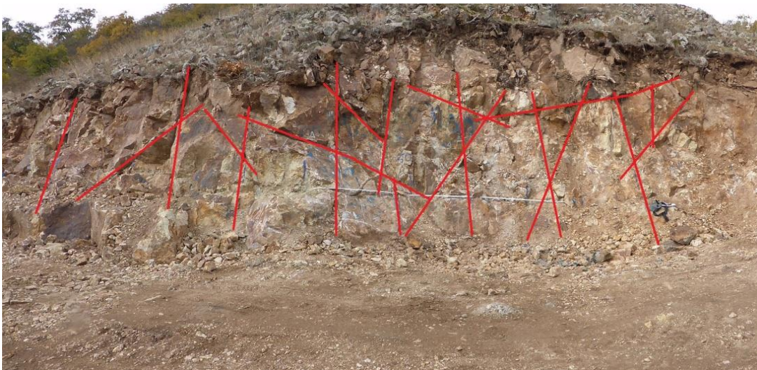
სურათი 5.3.6.2. ქანების ნაპრალოვნება გაკვარცებული ტუფების ხელოვნურ გაშიშვლებაზე. მუშევანი 2 საბადოს ჩრდილოეთი ფლანგი
