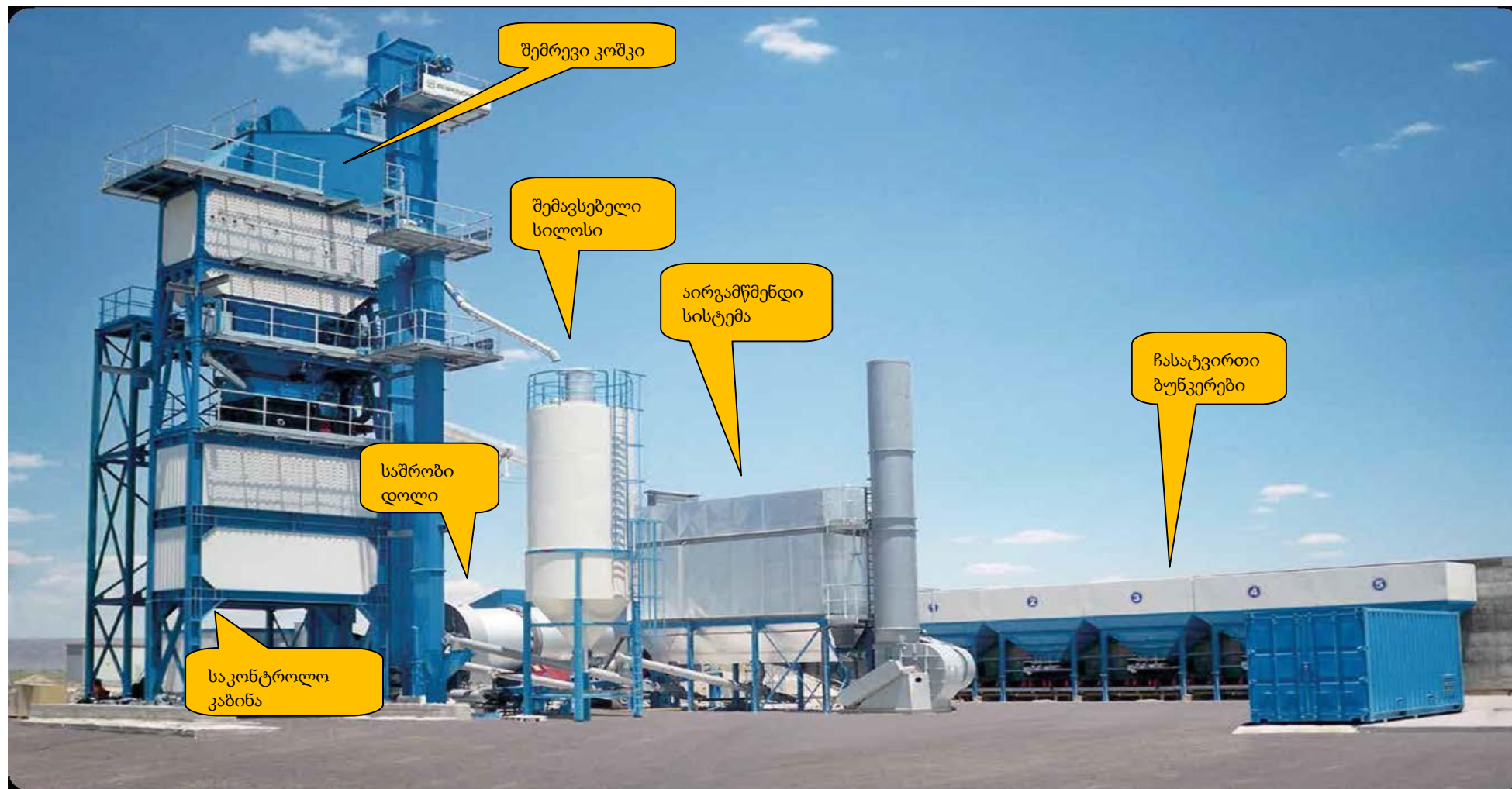
სურათი 3.2.1.2. კონტეინერული ტიპის ასფალტშემრევი ქარხნის BENNINGHOVEN, ECO-4000-ის საერთო ხედი
